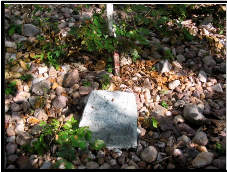
Foto 1 – Marco M0 – Estaca 0 do eixo da barragem
